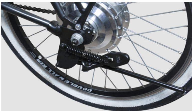
Per quanto riguarda la motorizzazione, Vivobike ha deciso di adottare per la VF20GR un **motore da 250W** integrato sul mozzo della ruota posteriore, che gli consente di raggiungere la velocità massima di **25km/h**, mentre la batteria al litio da 7.800mAh garantisce **percorsenze variabili tra i 25 e i 40 km** a seconda delle tipologie di percorsi e della velocità media degli spostamenti.
