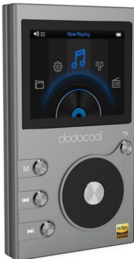
Nonostante l'aspetto un po' retrò, **dodocool DA106** ha caratteristiche moderne: è un lettore audio digitale Hi-Fi ad alte prestazioni con display da **2 pollici QVGA (320 x 240 pixel)**. Integra un processore ARM Cortex-M3 dual-core, 8GB di memoria interna espandibile con uno slot per schede microSD (fino a 256GB), un amplificatore **Texas Instruments TPA6130A2**, una porta microUSB e due uscite audio (line out e per il jack delle cuffie). La **batteria da 1400 mAh**
