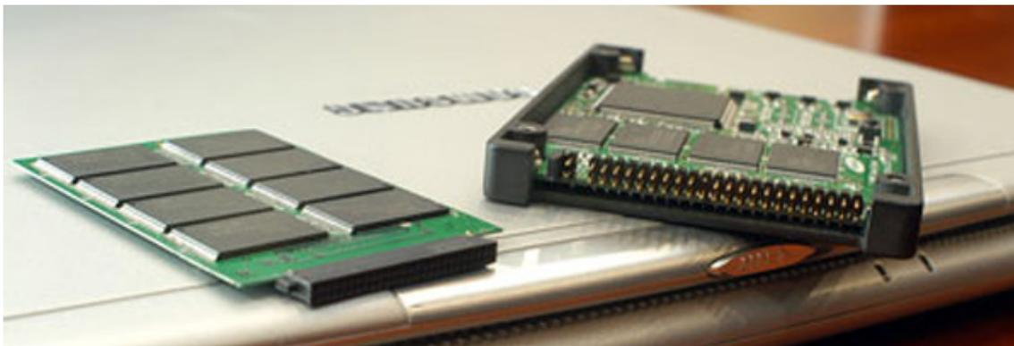
Ma di cosa si tratta? Gli hard disk della nuova serie MH80 sono delle unità di memorizzazione da 2,5" che sfruttano memorie flash OneNAND, capaci non solo di un maggiore bilanciamento delle prestazioni in lettura e scrittura, ma anche di ottimizzare la velocità massima di trasferimento dati.
