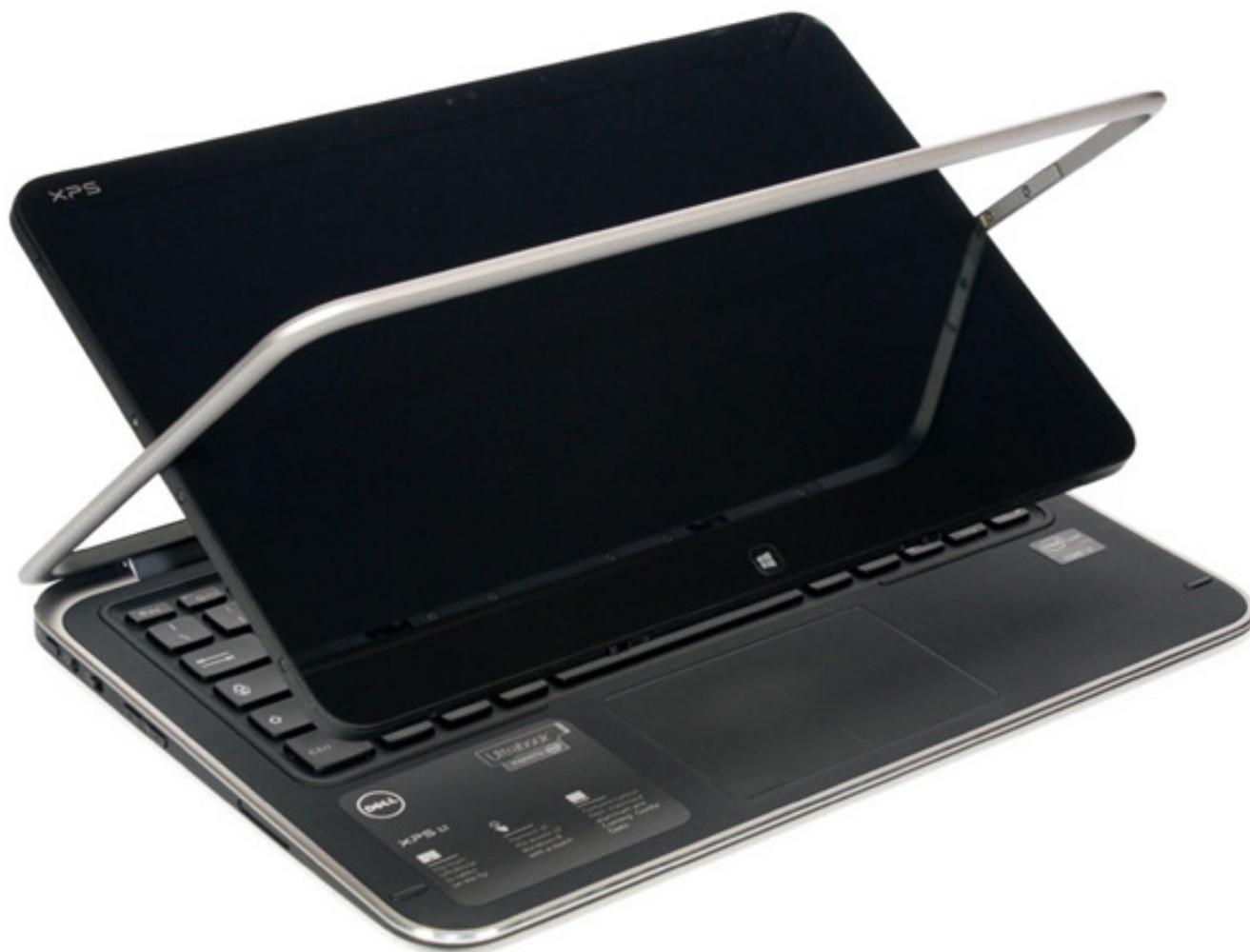
Ciò che identifica il Dell XPS 12 è il **meccanismo di conversione del display**. Lo schermo può ruotare sul suo asse orizzontale di 180°, ribaltandosi completamente e trasformando quindi il notebook in un tablet. Un sistema di guide magnetiche sul perimetro del pannello e quattro gancetti retrattili bloccano saldamente lo schermo nella cornice e non consentono di attivarne erroneamente la rotazione.
