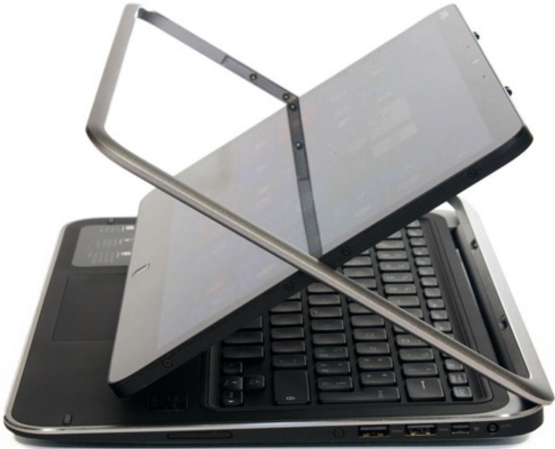
Il meccanismo così com'è stato realizzato è molto semplice ed efficace, sicuramente più intuitivo rispetto ad altre soluzioni in cui il display è completamente sganciabile o in cui qualche speciale cerniera pivotabile consente di ruotare lo schermo sul suo asse verticale per poi ripiegarlo sulla tastiera.
