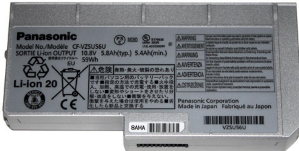
Secondo Panasonic, grazie a questo livello di efficienza energetica, la **batteria al litio** in dotazione da 62640 mWh riesce a fornire un'autonomia di circa 6 ore con una luminosità del display di 60 cd/m<sup>2</sup>, Windows Vista e la funzionalità ECO (Economy Mode) disabilitata che dovrebbe portare ad un risparmio del 20%.
