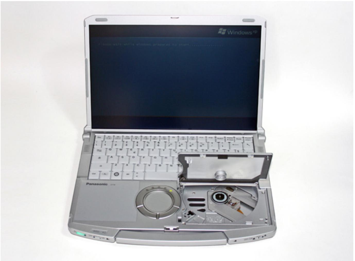
Il **drive ottico** è accessibile dall'alto, tramite il comodo sportello posizionato sul palm rest per evitare problemi dovuti ad uno spazio insufficiente lateralmente, e arriva a pesare appena 50,5 grammi.
