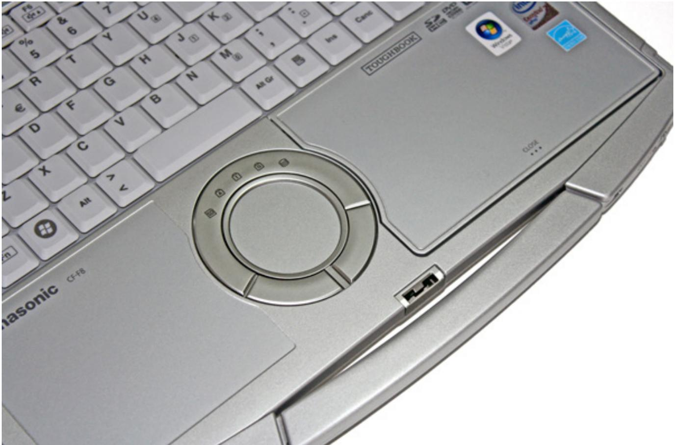
Entrambi i dispositivi di input sono adeguatamente protetti dalle infiltrazioni di liquidi mediante un sistema di scolo, ma vi auguriamo di non dovere verificare mai la sua efficienza.
