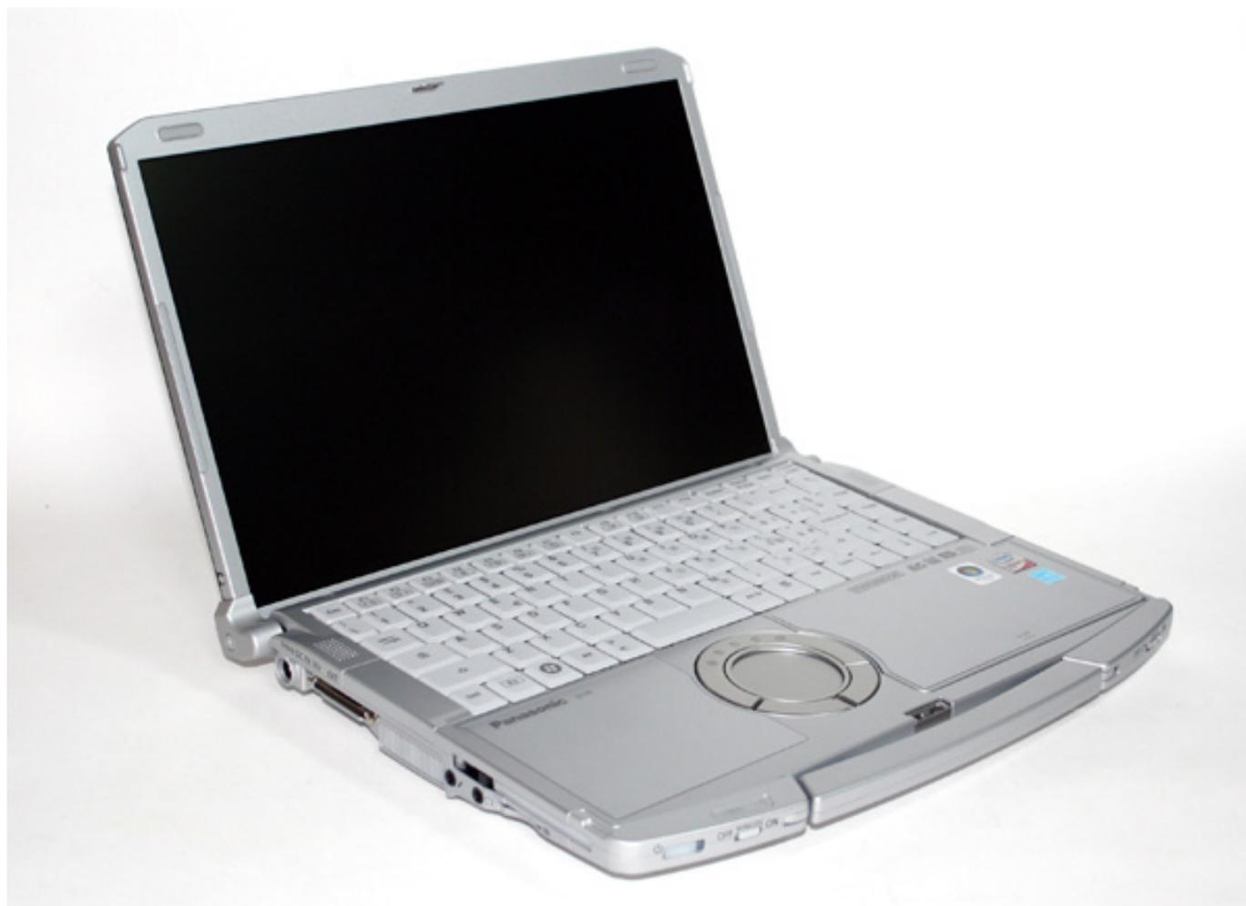
Molto convincente la rielaborazione della pratica **maniglia** che agevola il trasporto dei portatili Full Rugged e Semi-Rugged dell'azienda nipponica: non più una cinghia agganciata allo chassis, ma una maniglia rigida, inperniata sul bordo anteriore del telaio e snodabile.
