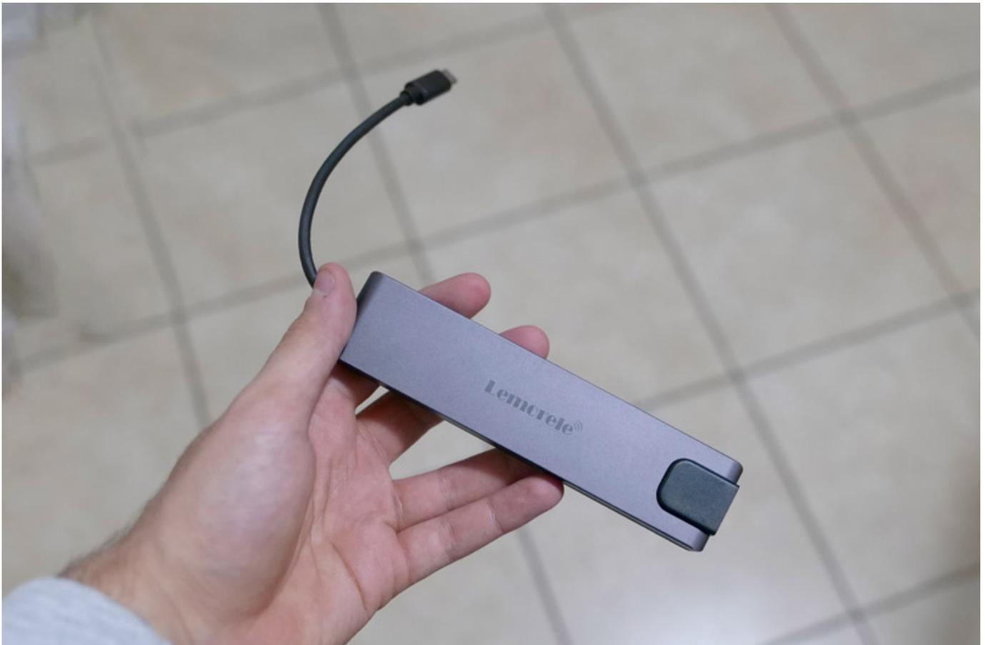
Tutti i più recenti ultrabook in circolazione possiedono - al massimo - un paio di porte, fondamentalmente delle **USB Type-C**, che hanno una tripla funzione: possono ricaricare il dispositivo, trasmettere il segnale video e garantire il trasferimento dati. Ed è sorprendente sapere che in realtà non ci serve molto altro, perché basta un hub USB per aggiungere altre interfacce in base alle nostre esigenze.
