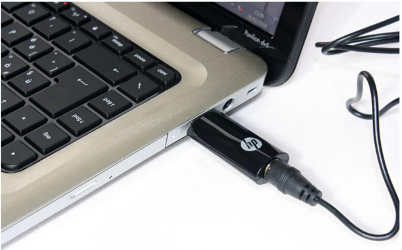
Nella confezione è anche presente un **tuner esterno USB** per la ricezione del segnale TV digitale terrestre (DVB-T), modello HP WF651AV. Il sintonizzatore TV può essere utilizzato in mobilità con l'antenna portatile in dotazione (provvista di clip per essere agganciata al display lid
