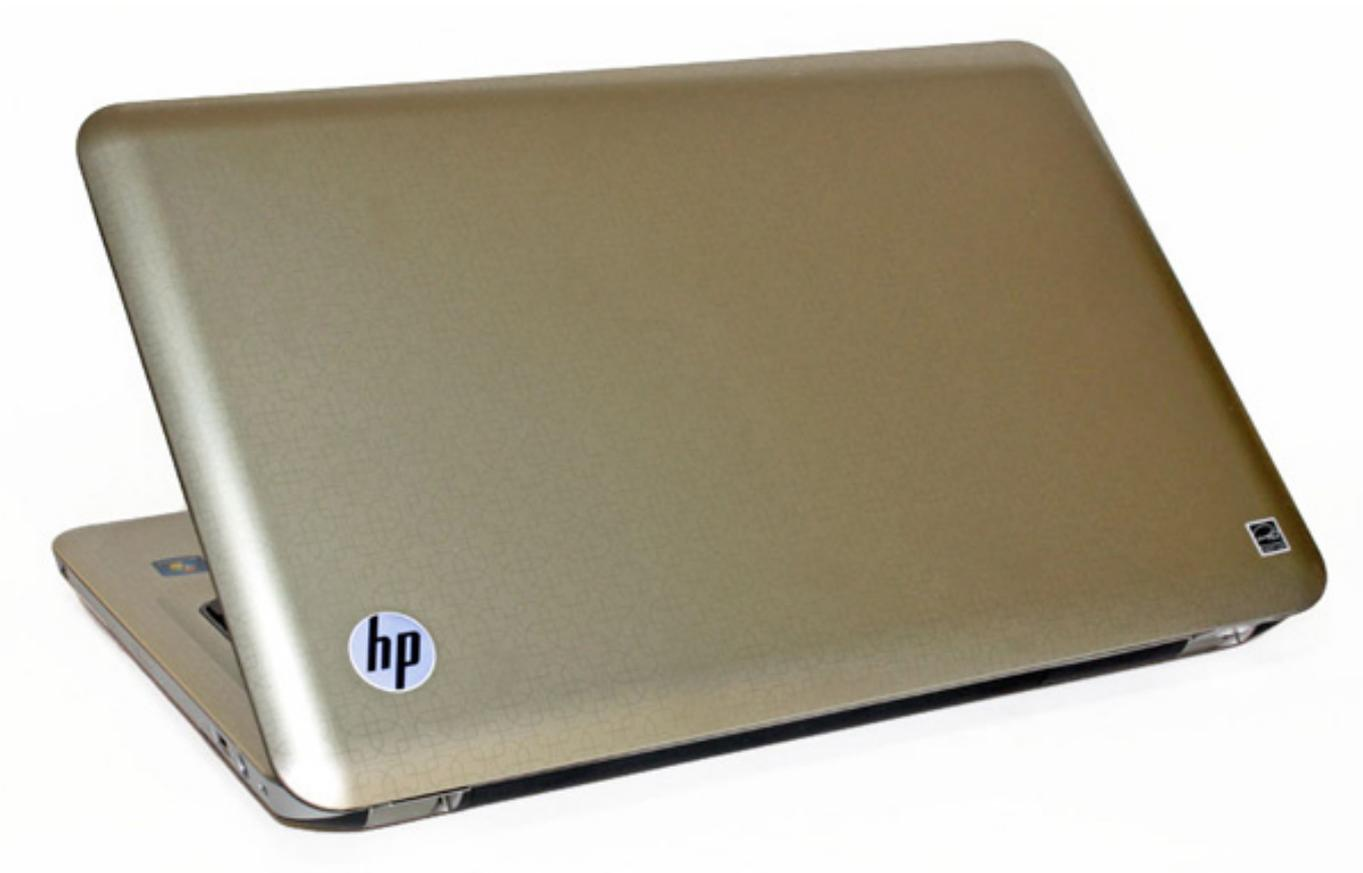
Il materiale utilizzato per lo chassis dell'HP Pavilion DV6-3034el è il policarbonato, leggero ed economico ma meno resistente dell'alluminio impiegato da HP per i Pavilion più accessoriati e per gli Envy. I lati sono ricoperti da una banda metallizzata molto semplice e accattivante, che circonda tutto il laptop, sottolineando l'assenza di spigoli.
