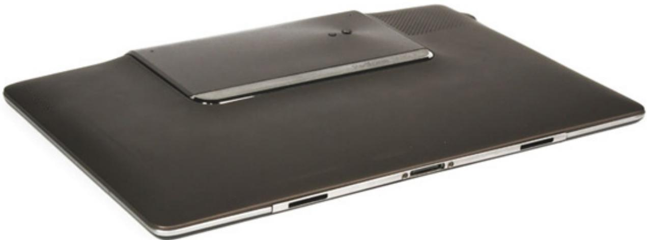
**Lato inferiore:** La base del dispositivo presenta due fenditure utilizzate per agganciare la Padfone Station alla Station Dock, e al centro di queste ultime è posto invece un connettore proprietario a 40 pin per lo scambio dati e l'alimentazione della Station.
