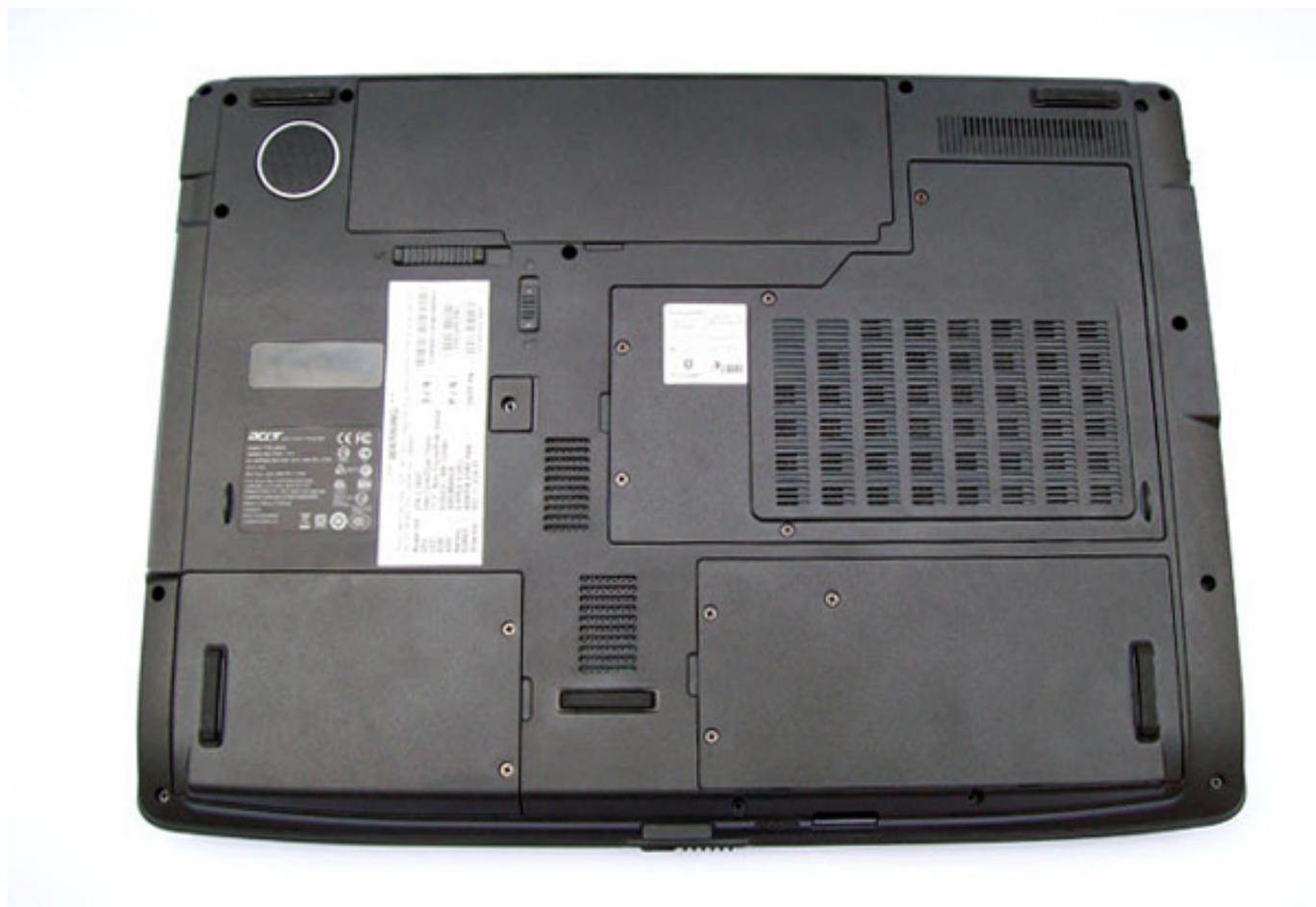
Capovolgendo il notebook scopriamo tre sportellini che chiudono altrettanti vani. Il primo, posizionato nella parte alta dello chassis, permette di accedere direttamente al sistema di dissipazione, alla CPU, alla memoria RAM e alla scheda video su modulo MXM tipo II.
