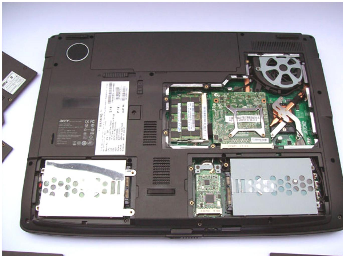
Quest'ultima caratteristica permette sia di effettuare la sostituzione della sola scheda in caso di guasti (consentendo di risparmiare notevolmente sui costi), sia di effettuare eventuali upgrade, anche se i costi delle schede MXM sono proibitivi.
