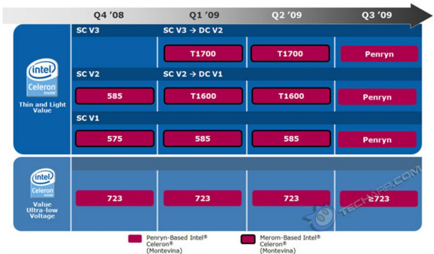
Le nuove CPU disporranno di 1MB di cache L2 ed FSB da 667MHz, mentre la frequenza di clock sarà di **1.66GHz per Celeron M T1600** e di **1.83GHz per Celeron M T1700**; l'utilizzo del vecchio core Merom a 65nm implicherà un TDP (Thermal Design Power) di 35W. Di ben altra
