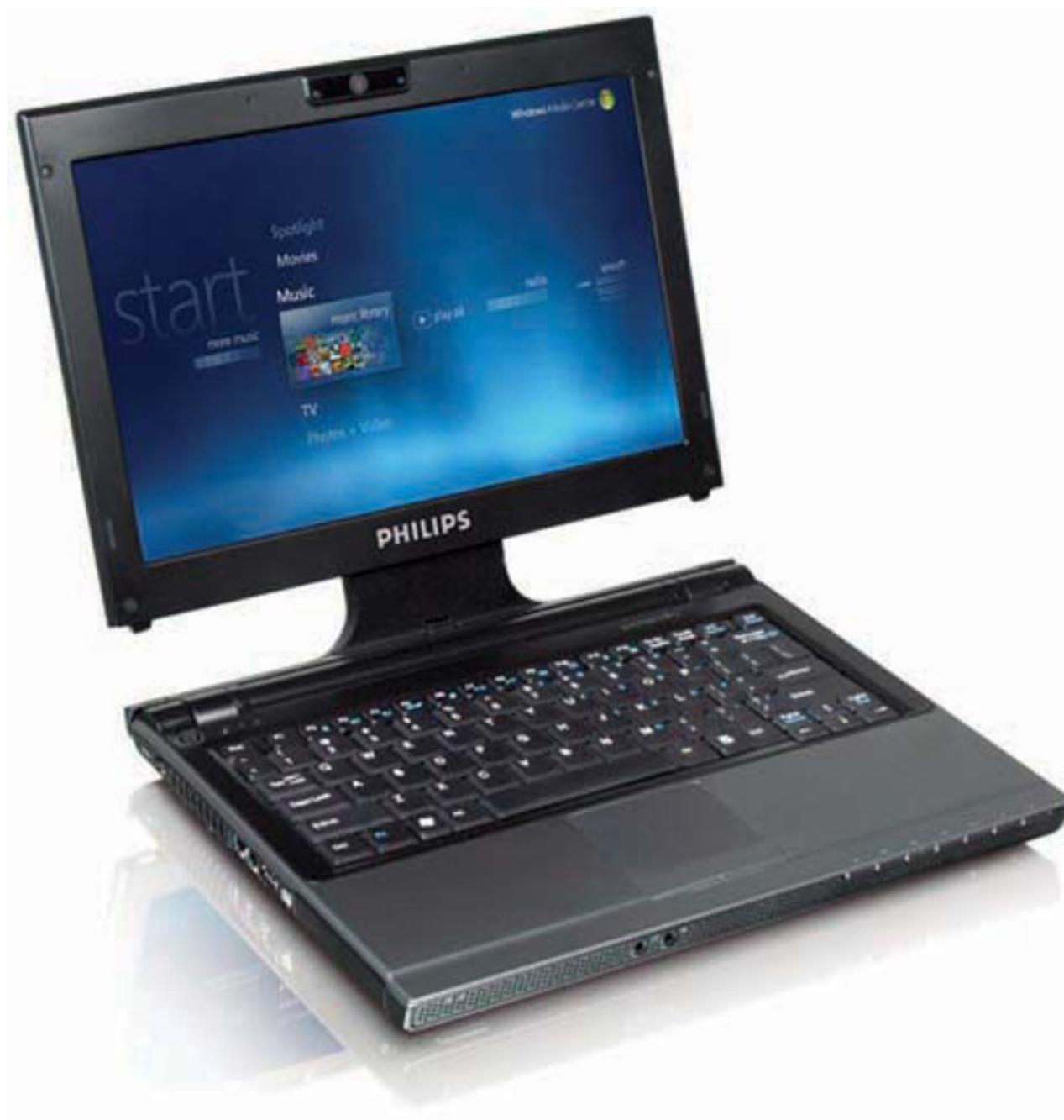
Questo sistema permetterebbe di spostare lo schermo in avanti, al disopra della tastiera, ottenendo una maggiore ergonomia durante la lettura o la riproduzione di filmati.
