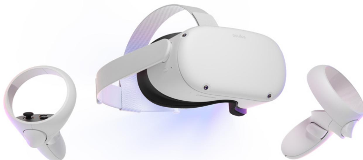
Dal punto di vista tecnico, Quest 2 è dotato di un processore **Qualcomm Snapdragon XR2**, **6GB di RAM**, doppio display a **90Hz Full HD (1832 x 1920 pixel)**, ovvero con il 50% in più di pixel rispetto al Quest originale.
