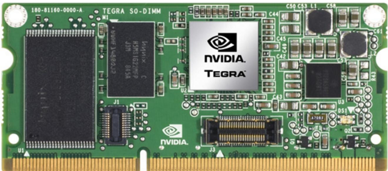
[Tegra 2](#), infatti, è una piattaforma basata su **architettura ARM** che integra al suo interno una componente grafica capace di leggere video HD e supportare l'accelerazione hardware 3D. Il presidente di Nvidia ha recentemente dichiarato che il chip **Tegra 2 è più efficiente del chip A4**, presente nel tablet Apple iPad e basato su architettura ARM, soprattutto nella lettura di contenuti Flash.
