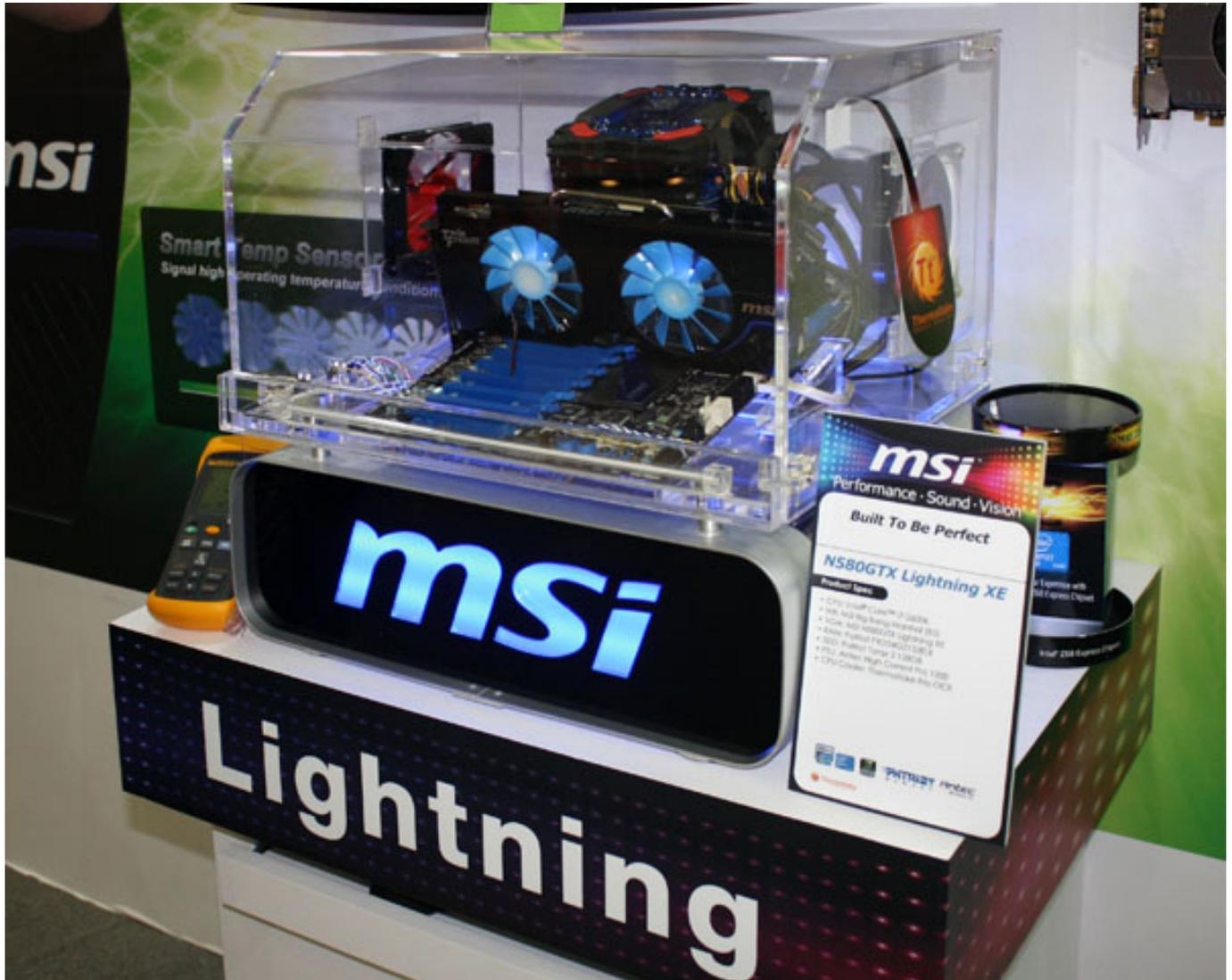
MSI N580GTX Lighting Xtreme Edition, in particolare, adotta tecnologie e materiali innovativi, come le ventole Propeller Blade, che introducono le soluzioni Smart Temp Sensor (la ventola cambia colore in base alla temperatura, segnalando in modo visivo quando il calore diventa eccessivo) e Dust Removal (all'accensione le ventole ruotano in senso inverso per qualche secondo per espellere la polvere).
