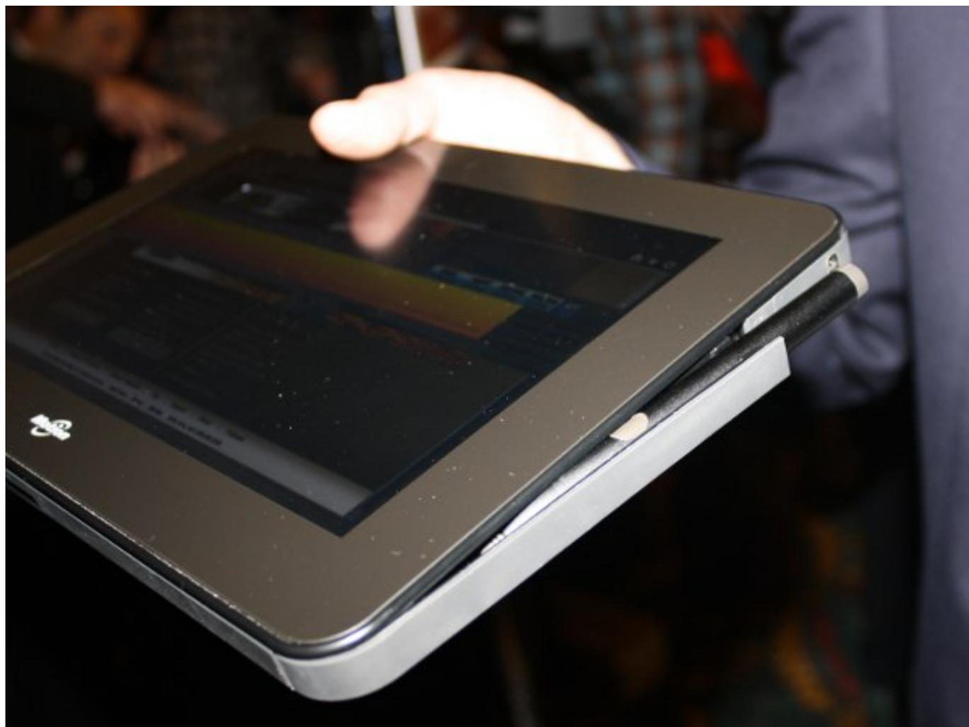
Di conseguenza, Motion Computing ha rafforzato il suo tablet per funzionare anche dopo **cadute da 1.20 metri, da urti e polvere**. Il vetro **Gorilla Glass**, inoltre, protegge lo schermo e garantisce una solidità quattro volte superiore a quella di un display classico. Grazie a Windows 7, il tablet può essere utilizzato con il **dito o con uno stilo fornito** in dotazione, che supporta il riconoscimento della scrittura, interessante per prendere appunti sul campo.
