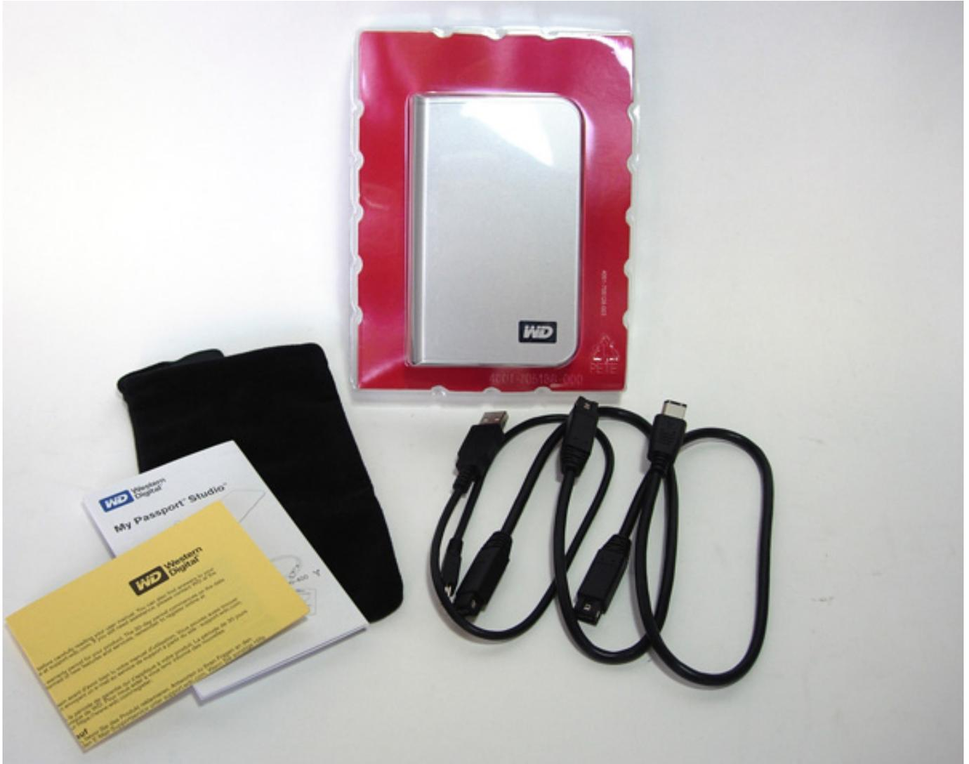
Già formattato per sistemi Macintosh, l'hard disk Western Digital può essere collegato velocemente ad un computer portatile grazie alla presenza di più interfacce, quali FireWire 800, FireWire 400 e USB 2.0. Quest'ultima consente di utilizzare agevolmente l'HDD di WD anche sui comuni netbook e notebook. Come molti storage esterni, My Passport Studio non offre però un'interfaccia eSATA.
