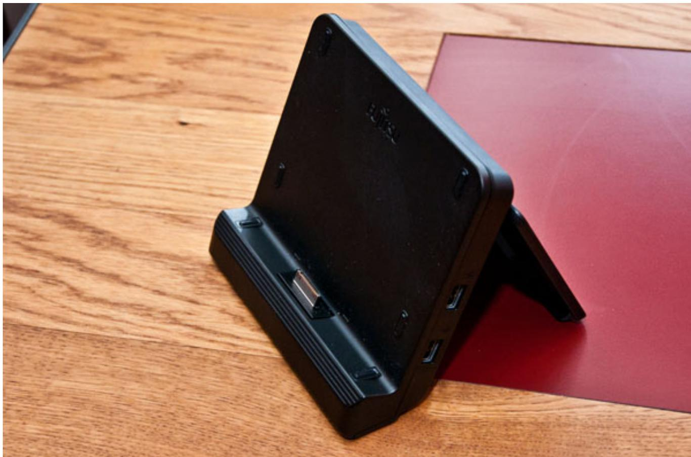
Infine, per chi invece dovesse necessitare di maggior flessibilità ed espandibilità, c'è anche lo **Stylistic Q550 Cradle**, una **docking station** che permette di tenere il tablet in verticale, con possibilità di regolarne l'angolo di inclinazione per favorire sempre la massima leggibilità e comodità, ricaricarne la batteria e connettere altre periferiche grazie alle quattro porte USB aggiuntive.
