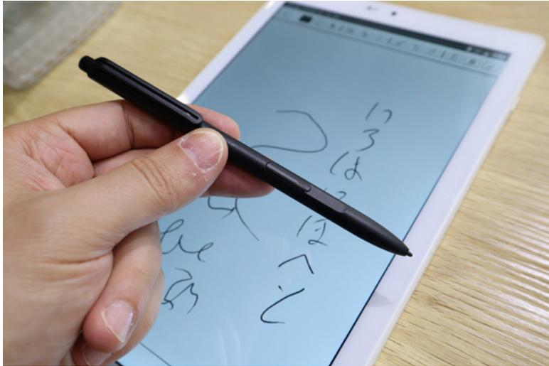
**EeWrite T3** appartiene alla famiglia degli ePad ma, rispetto ai primi due, non supporta la penna Wacom piuttosto la **E Pen**, che contiene una batteria AAAA e riconosce fino a 1024 livelli di sensibilità alla pressione. EeWrite T3 ha grossomodo lo stesso design e le stesse specifiche tecniche di EeWrite E3: display IPS da **10.1 pollici Full HD** (1920 x 1200 pixel), **MediaTek MT8768**, 4/64GB di memoria, 4G-LTE opzionale, USB Type-C e **Android 9.0 Pie**.
