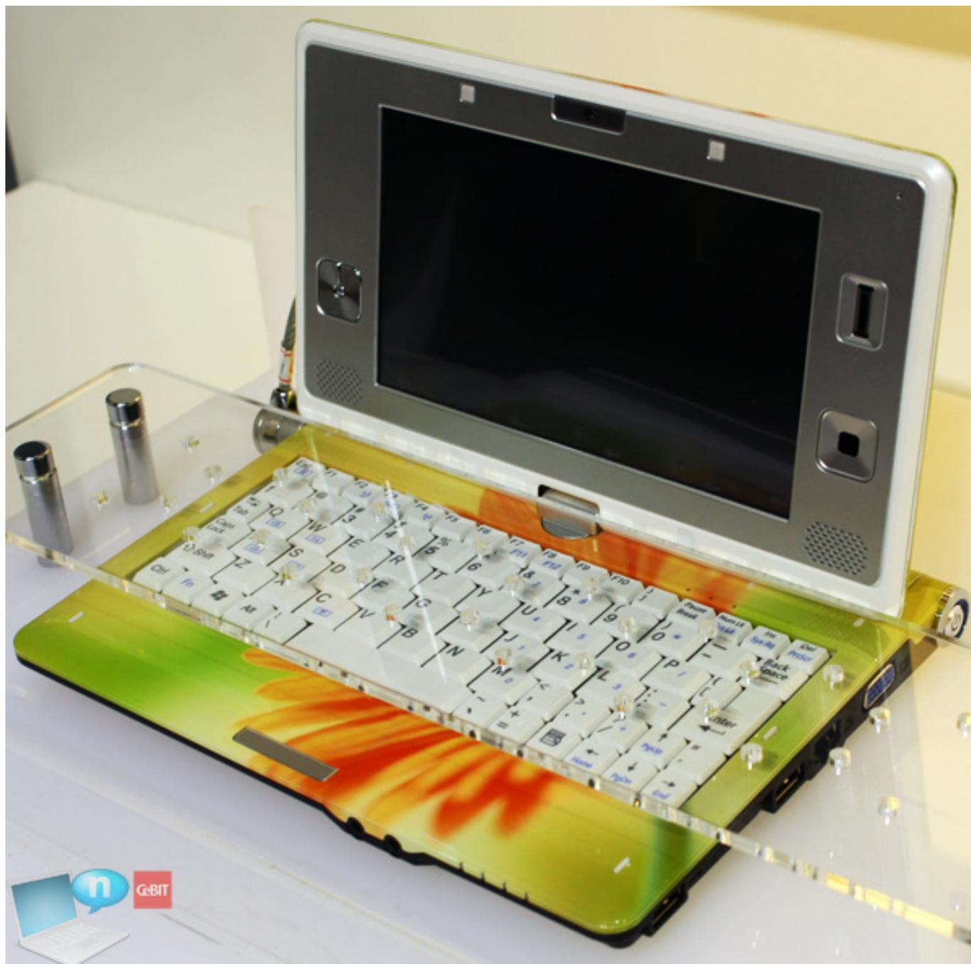
Con un'ampia dotazione di porte tra cui riconosciamo 2 USB, External CRT, jack audio, RJ-45, DC-in, card reader 5in1, slot Expresscard/34 e MiniCard, **Clevo TN71M** è provvisto di connettività 802.11b/g, Bluetooth v2.1, **modulo GPS**, Ethernet 10/100 e webcam integrata da
