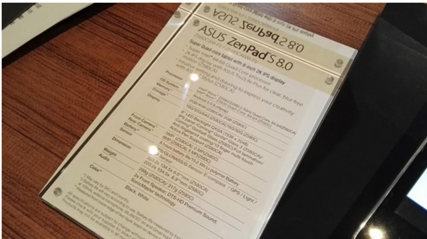
Restano invece invariati fra i due modelli il pannello IPS con risoluzione 2K di 1536x2048 pixel, l'audio DTS e la batteria da 15.2 Wh capace di alimentare il tablet per 8 ore. **ASUS Italia non ci ha ancora fornito indicazioni ufficiali circa la commercializzazione ed il prezzo** dello Zenpad S 8.0 nel nostro Paese ma possiamo ricavarlo con un certa approssimazione a partire da quello americano pari a 199\$.
