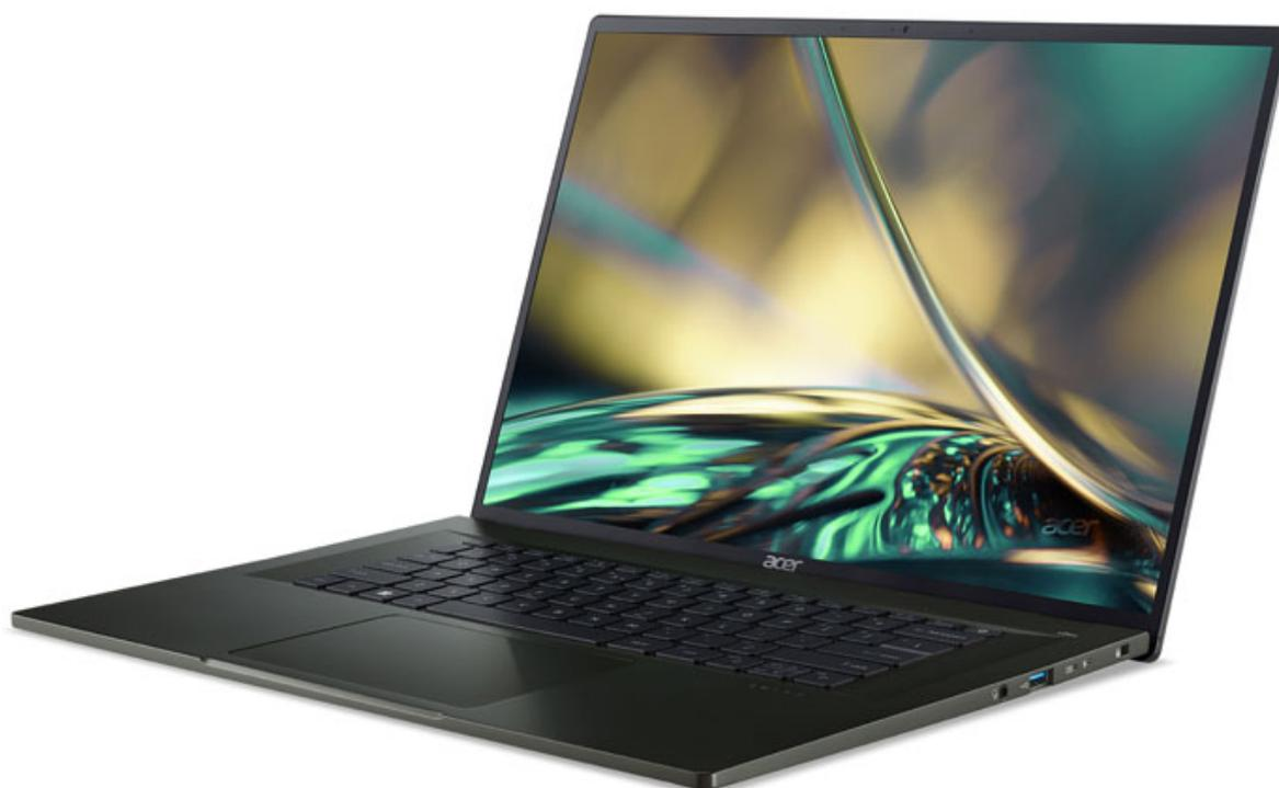
A bordo, troviamo ovviamente anche una tastiera retroilluminata ma priva di tastierino numerico, due altoparlanti e una webcam Full HD con microfono (lente in vetro blu). Non manca **Wi-Fi 6E ax (2x2)** e **Bluetooth 5.2**, un'uscita video HDMI 2.1, un jack audio combo, due porte USB 3.2 e due USB 3.2 Type-C (Gen2). La batteria a 3 celle (54Wh) dovrebbe assicurare fino a 7.30 ore di autonomia annunciata.
