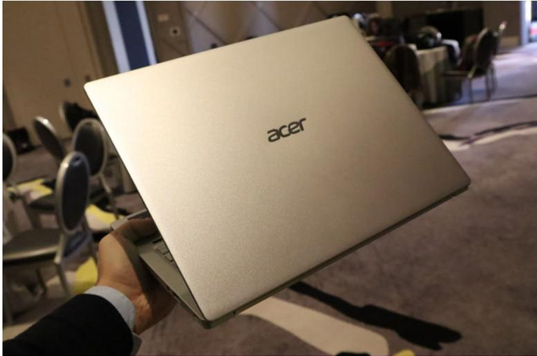
L'Acer Swift 3 (SF314-42) è caratterizzato da uno chassis in **alluminio, magnesio-alluminio e plastica** (attorno al display), ma è leggermente più spesso (16.55 mm) e più pesante (1.2Kg) della variante Intel-based per la presenza di uno schermo da **14 pollici Full HD (1920 x 1080 pixel)** con cornici ultrasottili per un rapporto screen-to-body dell'82.73%.
