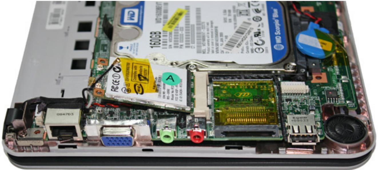
La scheda wireless, collocata in uno slot PCI-Express, viene identificata anche con la denominazione commerciale di MSI 6890 e fa uso di un chipset Ralink RT2860 che assicura buone performance ed un supporto software piuttosto completo. Su un dispositivo così votato alla mobilità può essere avvertita la mancanza di un modulo 3G, per connettersi ad Internet direttamente attraverso la rete cellulare, ma probabilmente lo spazio disponibile era stato già saturato dal doppio dispositivo di storage.
