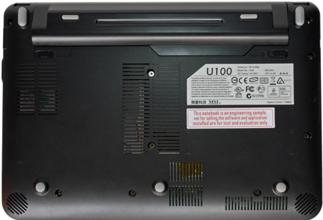
Tuttavia, un'analisi più approfondita rivelerebbe il nostro errore: tutto il fondo è costituito da un unico pannello unito alla base tramite 9 viti! Basta svitarle e rimuovere la copertura per guadagnare l'accesso alla motherboard ed a tutti i principali componenti hardware.
