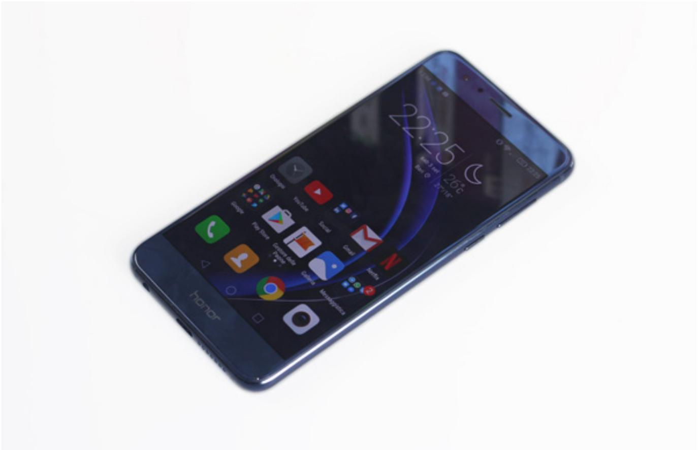
Tecnicamente si tratta di un **display JDI, Japan Display Inc., IPS-Neo LTPS di tipo in-cell**. La tecnologia in-cell riduce gli strati di cui si compone il touchscreen per una maggiore reattività e precisione al tocco e per una migliore brillantezza. Il valore di luminanza dichiarato è di 500 candele, non troppo lontano da quello reale di circa 450 candele rilevato dallo spettrofotometro
