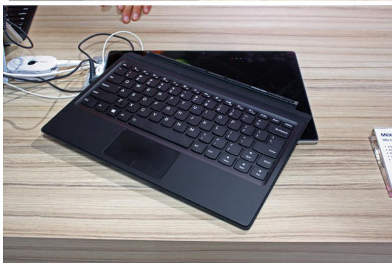
La **tastiera dock** invece si collega alla base del tablet con forti magneti, che trattengono saldamente lo schermo inclinandolo di qualche grado. La digitazione è confortevole, ergonomica e ben stabile, anche grazie ai tipici tasti "Accutype" concavi con una maggiore corsa e alla retroilluminazione.
