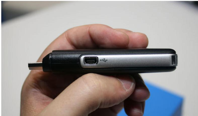
Oltre a queste due porte il device ospita comunque anche un lettore di memorie microSD e una seconda porta USB di tipo OTG (On The Go), che consente cioè di interfacciare altri dispositivi senza bisogno di passare per un computer. All'interno invece troviamo il SoC RockChip RK3066 con processore **dual core ARM Cortex A9** da 1.6 GHz, abbinato a 1 GB di RAM e a 8 GB di memoria interna, mentre il sistema operativo è Google Android. Presenti anche i moduli WiFi e Bluetooth.
