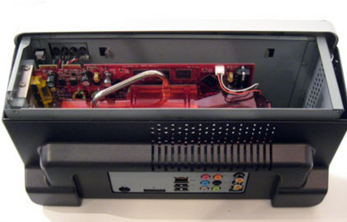
Anche se **l'impiego dello slot ExpressCard potrebbe risultare in parte limitante per le prestazioni** di una scheda grafica da desktop, perché opera su un singolo canale con una velocità di trasferimento dati di 2.5 GB/s (contro i 4 GB/s del BUS PCI Express x16), tuttavia questa soluzione consentirebbe comunque agli utenti di aumentare le prestazioni grafiche del proprio computer portatile, garantendo l'utilizzo di applicazioni e videogames di ultima generazione.
